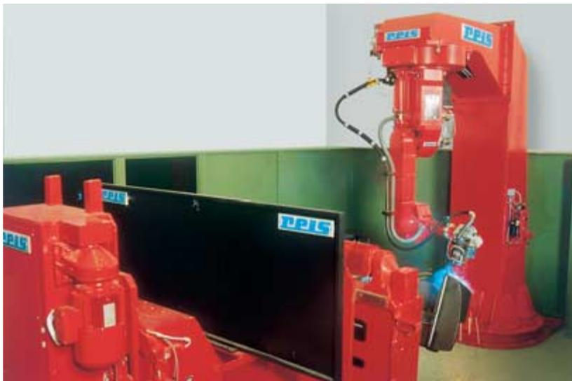
La fabricación en acero del bastidor del carro se realiza con ayuda de un robot de soldadura de 10 ejes. Mediante este robot se garantizan tiempos de recorrido cortos y una soldadura idéntica.
