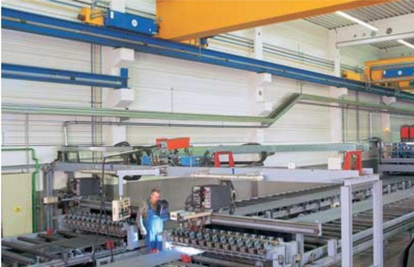
En la instalación de soldadura controlada por ordenador se sueldan las chapas en las longitudes necesarias para las vigas cajón. La máquina de soldadura a tope procesa chapas de distinto espesor. El sistema de seguimiento automático de costura garantiza la máxima calidad de las juntas.
