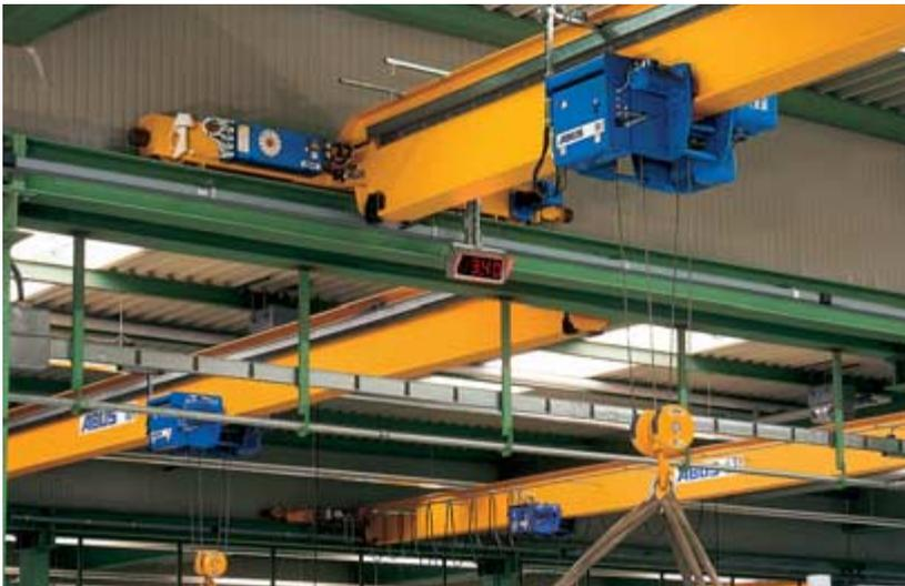
Como accesorio opcional puede instalarse una pantalla para indicación de carga, visible a larga distancia, que informa sobre el peso suspendido del gancho.
