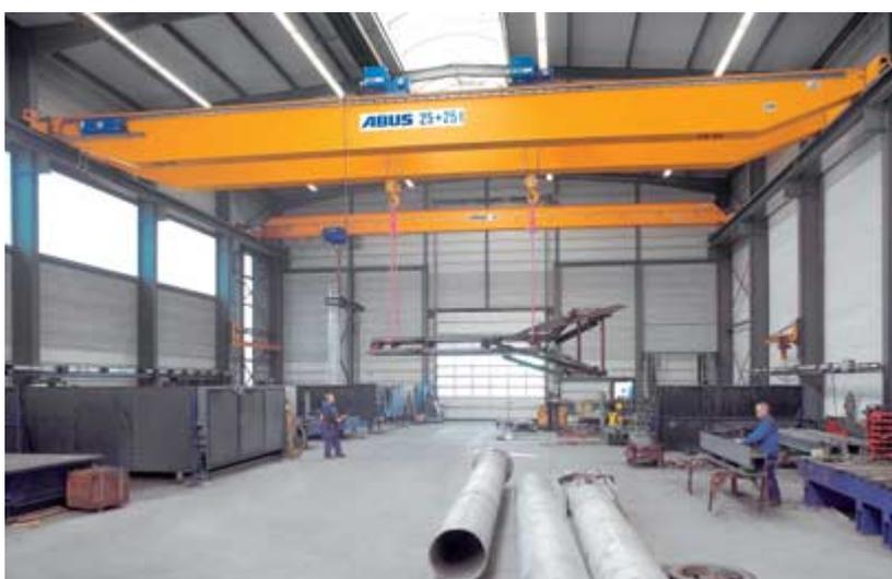
El control de motor simultáneo permite la elevación uniforme de cargas con varios polipastos. Incluso con una distancia de gancho corta se puede lograr siempre una óptima y segura posición de la carga.
