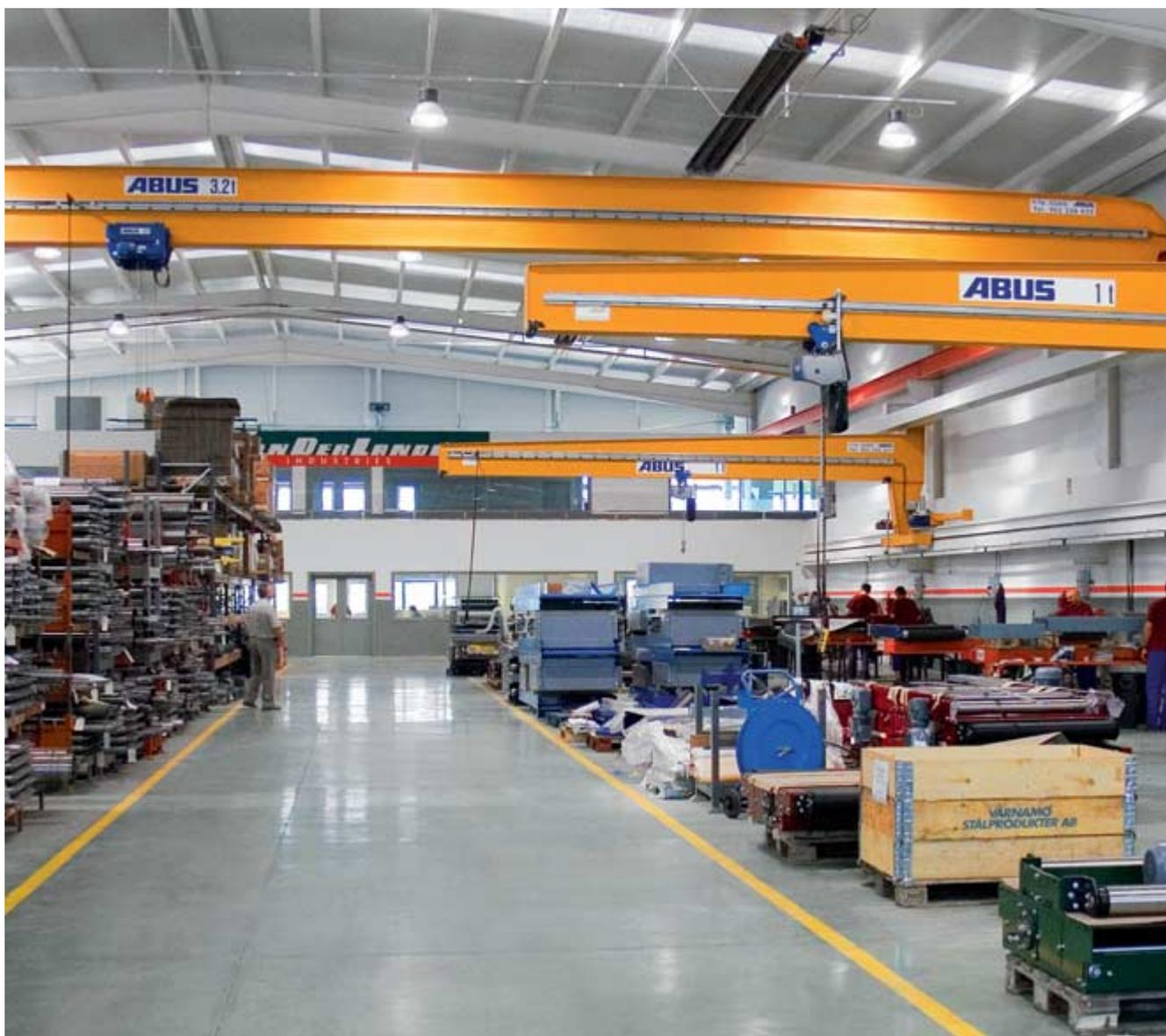
Las guías de consola monorraíles de ABUS se mueve en su propio nivel por debajo de los grandes puentes grúa. El flujo de materiales se acelera con la ampliación de las posibilidades de transporte en otros ámbitos de la producción.
