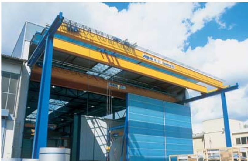
En las salidas al exterior, un circuito controlado por el puente grúa de ABUS se ocupa de activar las compuertas de la nave.
