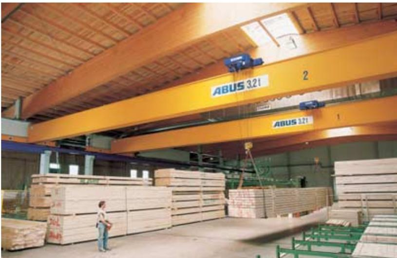
El funcionamiento en tándem de dos puentes grúa facilita el transporte de cargas muy voluminosas.
