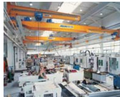
**Grúas de consola monorraíl,** para grúas independientes con su propia viga carril por debajo de otros puentes, en un segundo nivel. La solución ideal para mantener varios puestos de trabajo al mismo tiempo. La grúa de consola monorraíl de ABUS EKL tiene un alcance de brazo de hasta 12 metros y una capacidad de hasta 5 t.
