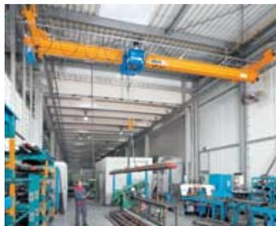
**Puentes grúa suspendidos ABUS.** Para naves de características especiales, en las que la viga carril de la grúa no se apoya en columnas o salientes, sino que se suspende del techo. Las reducidas cotas de aproximación de carro permiten una máximo aprovechamiento del ancho de la nave.
