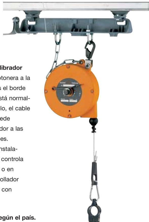
Con el **enrollador-equilibrador ABUS** se mantiene la botonera a la altura deseada. Mientras el borde inferior de la botonera está normalmente a 1 metro del suelo, el cable de la línea de mando puede adaptarse con el enrollador a las circunstancias individuales. Suele ser necesario en instalaciones donde la grúa se controla desde diferentes niveles o en fosos de montaje. El enrollador ABUS se puede adquirir con 3 ó 4,5 metros de cable.
