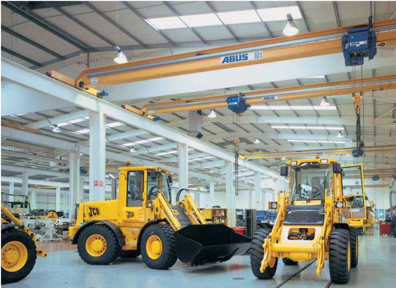
Con los puentes grúa monorraíles se puede solucionar el transporte de materiales con capacidades de carga de hasta 16 t y luces de hasta 39 m incluso en naves de techo bajo. Ya que para puentes grúa monorraíl no se requiere una distancia de seguridad hasta el techo dentro de esta gama de capacidades, pueden aprovecharse al máximo las circunstancias espaciales ahorrando costes de reestructuración de nave.
