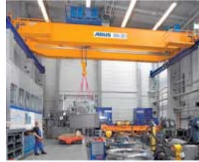
**Los puentes grúa birraíles ABUS** soportan hasta 120 t\*, la máxima capacidad de carga. Están disponibles con viga cajón soldada y ofrecen las mejores condiciones para aplicaciones adicionales. Por ejemplo: mayor velocidad de traslación de grúa, pasarelas de mantenimiento, carros con pasarela o polipastos auxiliares, todo ello sin complicaciones.
