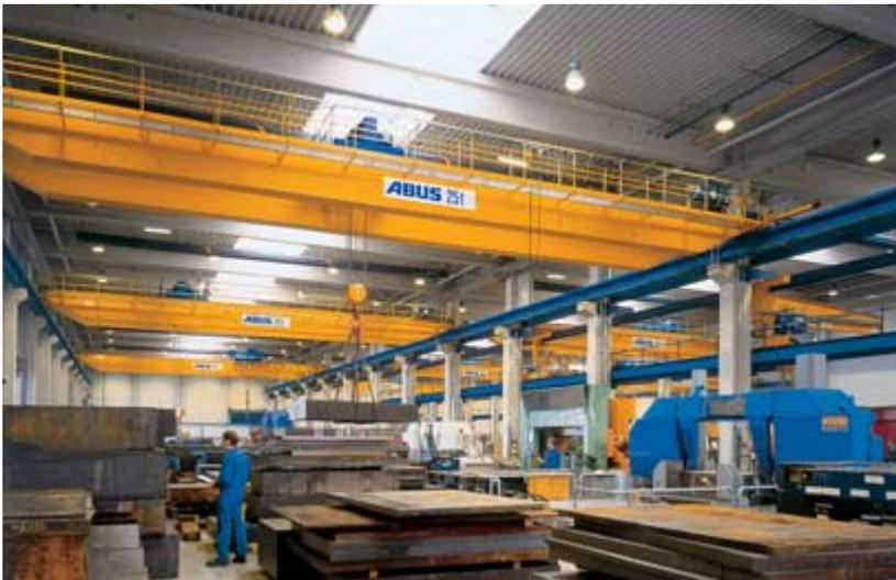
El equipamiento de las grúas con pasarelas de mantenimiento y carros accesibles permite llegar a todos los elementos con la ventaja que supone en la realización de trabajos de reparación y mantenimiento.
