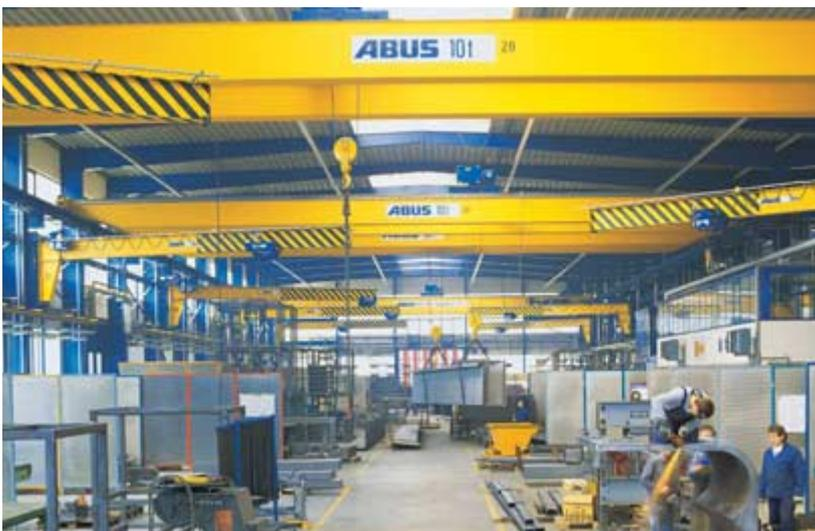
Los polipastos de cable de dos ramales alcanzan velocidades de elevación especialmente altas y pueden levantar hasta 20 t. Las grúas pluma murales ofrecen máxima flexibilidad en el segundo nivel de trabajo.
