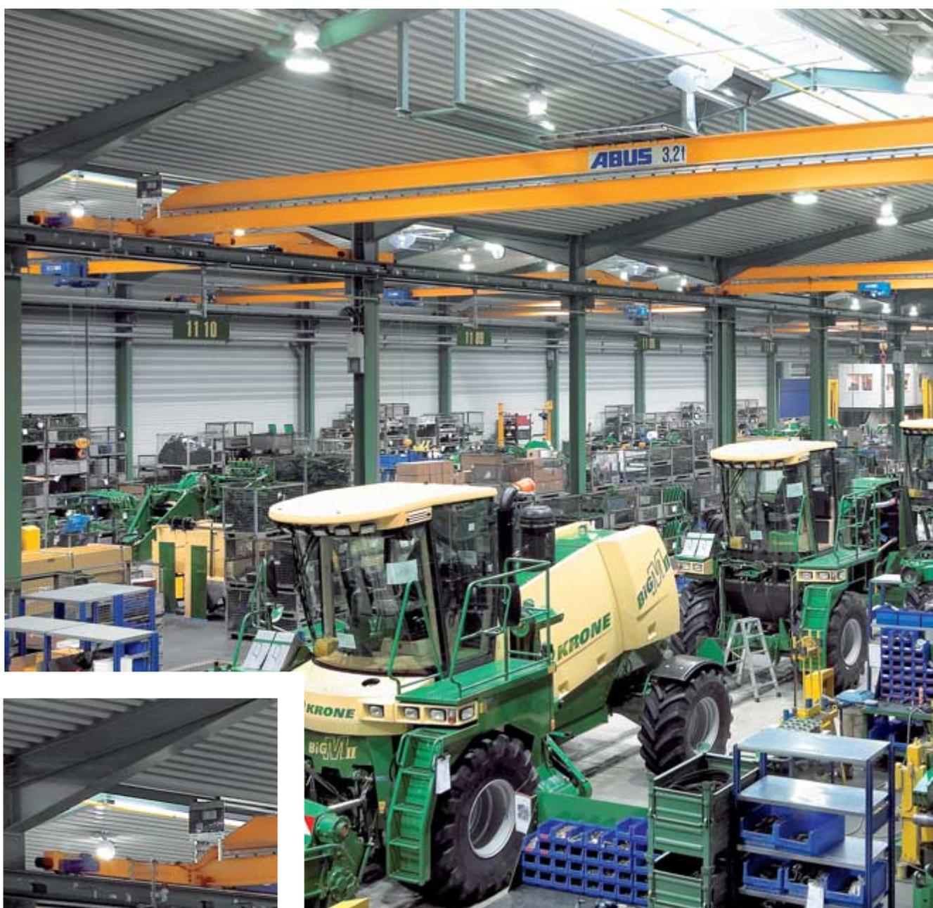
La solución ideal para naves de nueva construcción: El puente grúa monorraíl de ABUS ELK con extremos inclinados para adaptarse a la moldura arquitectónica (variante 3). De esta forma se aprovecha al máximo la altura disponible de la nave.
