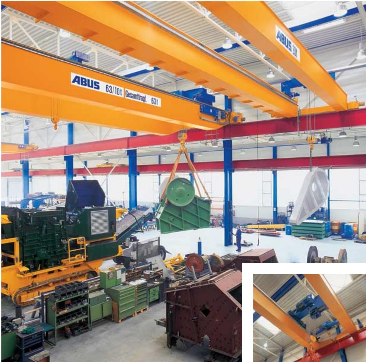
La colocación del testero sobre ocho ruedas permite un adecuado reparto de la carga. Con la misma viga carril se pueden transportar cargas mayores sin tener que reforzar la estructura de las naves.
