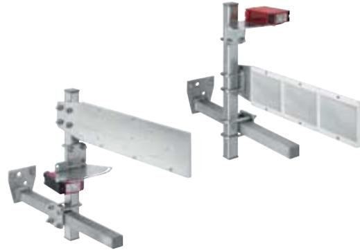
El Seguro anticolidión ABUS previene posibles choques cuando hay más de una grúa en los mismos carriles. La variante normal, que conmuta automáticamente a la velocidad lenta cuando hay aproximación puede ampliarse con una desconexión completa final. Se pueden diseñar versiones especiales para aplicaciones peculiares, como por ejemplo, mantener una distancia de seguridad determinada.
