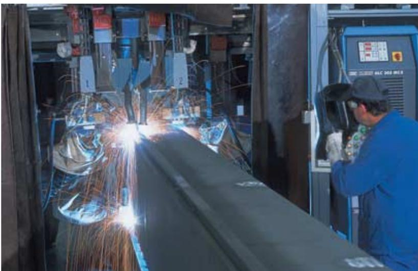
La instalación móvil de soldadura de portales construida por ABUS realiza hasta seis soldaduras simultáneamente para fijar las almas a las cabezas superior e inferior y para fijar las guías de los carros en la parte superior de la viga. Los quemadores de alto rendimiento se controlan por ordenador. Una vez soldadas las chapas terminales y montados los testeros, la grúa se somete al sistema de lacado correspondiente a cada necesidad.
