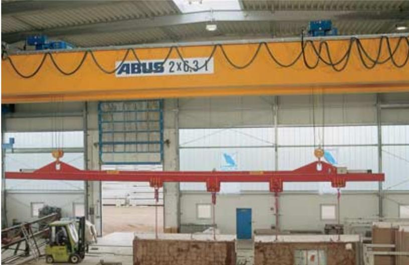
En el transporte de materiales largos con travesaños, dos carros de traslación simultánea se encargan de un posicionamiento estable.
