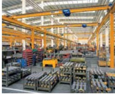
**Los puentes grúa monorraíles ABUS** garantizan un flujo de material óptimo, donde las condiciones de las naves y almacenes no dejan mucho espacio para grúas. Los puentes grúa monorraíl de ABUS se pueden suministrar con viga de perfil laminado o con viga cajón soldada. Según las necesidades, se pueden hacer montajes que ahorran mucho espacio y permiten una máxima altura de gancho.
