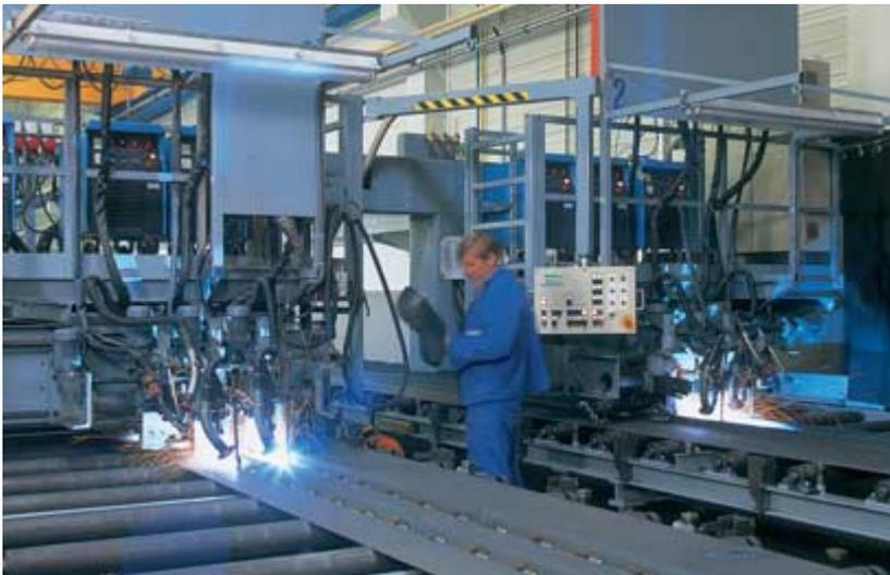
Antes de comenzar el paso siguiente, se aseguran las almas con rigirizadores longitudinales soldados para evitar deformaciones. La estabilidad total de la forma se logra con chapas de mamparo. Una vez realizado el montaje se prepara la viga cajón para la máquina de soldadura de portales.
